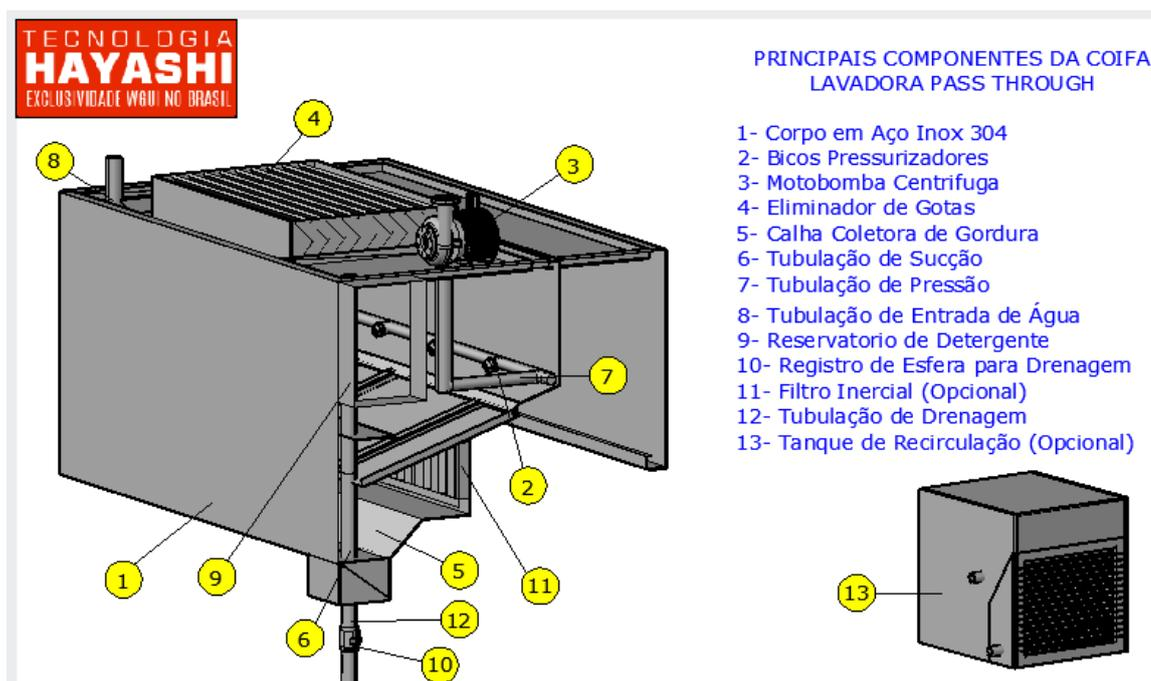
Seu dimensionamento foi efetuado como descrito em norma, sendo dotado de filtros do tipo inercial com anteparos nas suas bordas e canaletas laterais, dotados de botões para captação e drenagem da gordura.
